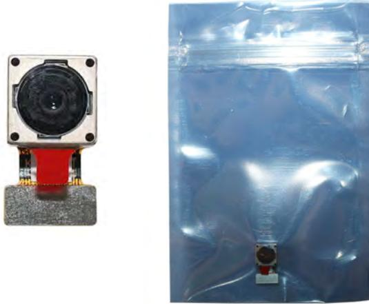
Coloque los conectores en la bolsa antiestática.
